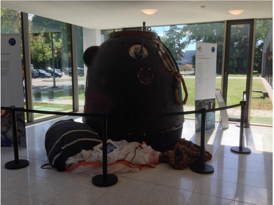
Im Foyer des Casinos ist zurzeit die Sojus Landekapsel ausgestellt, mit der Alexander Gerst aus dem Weltall am 10. November 2014 auf die Erde zurückkehrte. Die durch die Reibungswärme beim Wiedereintritt in die Erdatmosphäre verrußte Kapsel hat eine kreisförmige Grundfläche mit einem Durchmesser von 2,17m und bietet für die drei Kosmonauten sehr wenig Platz. Das bewohnbare Volumen der Kapsel beträgt  $3,5\text{m}^3$ . Dies entspricht ungefähr dem Siebenfachen des Kofferrauminhalts
