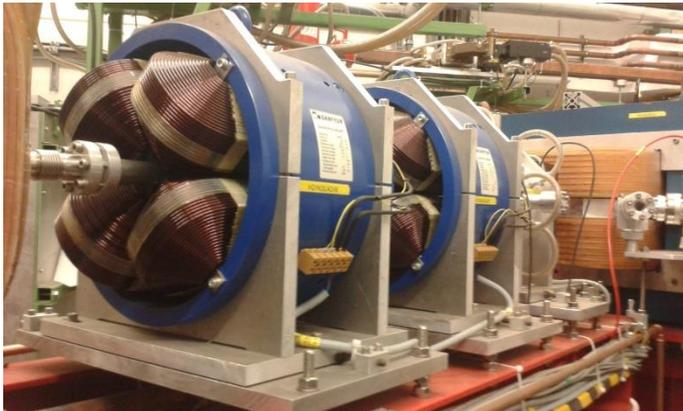
*Quadrupolmagnet zur Bündelung des Elektronenstrahls nach einer Kurve*
