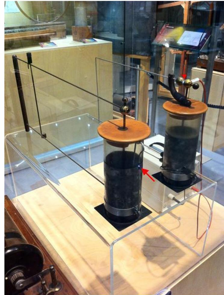
Die einzelnen Schwingkreise bestehen aus einer Leydener Flasche. Sie übt die Funktion eines Kondensators aus und speichert die elektrischen Ladungen. Die Metallschleife bildet die Spule zur Erzeugung eines Magnetfeldes. Die Größe der Empfängerschleife ist veränderbar, so dass die Signalübertragung bei gleicher Frequenz von Sender und Empfänger möglich ist.
