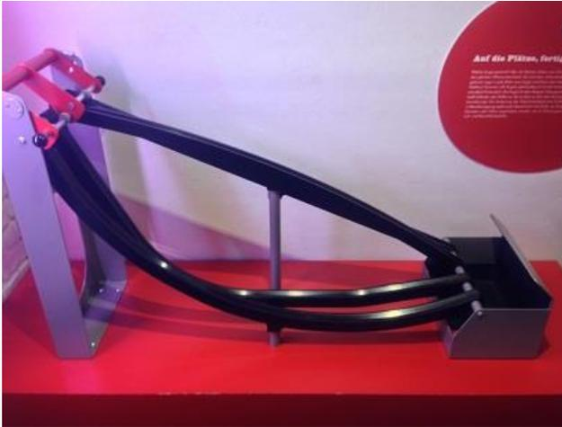
Die abgebildete Kugelrollbahn zeigt vier verschiedene Wege von oben nach unten. Alle haben den gleichen Höhenunterschied und trotzdem erreichen die Kugeln zu unterschiedlichen Zeiten das Ziel.
