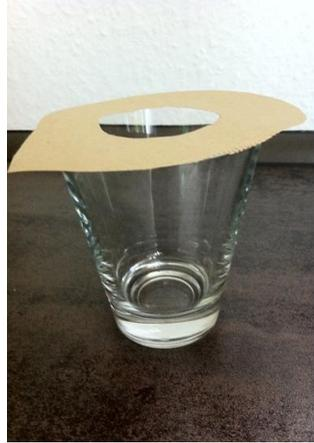
Das Filterpapier wird zu einem Dichtungsring zurecht geschnitten, leicht angefeuchtet und auf das erste Glas gelegt.
