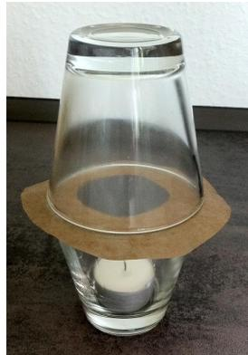
Jetzt stellt man das angezündete Teelicht in das untere Glas und presst das zweite Glas umgekehrt von oben auf das erste Glas. Nach dem Erlöschen der Flamme und einem kurzen Zischen können beide Gläser gemeinsam angehoben werden.
