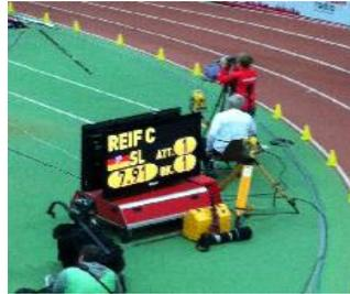
Die Datenaufzeichnung und Auswertung von Messwerten sind wichtige Bestandteile der modernen Trainingsmethodik. Mit Videokamera und Laserstrahl werden Bewegungsabläufe aufgezeichnet und Geschwindigkeiten gemessen. Die aufgezeichneten Videos können zum Beispiel mit dem von uns in der Schule verwendeten Programm „Galileo“ analysiert werden.
